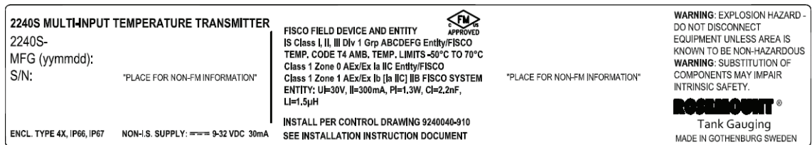
Figura B-1. Etiqueta de aprobación de seguridad intrínseca de Factory Mutual, EE.UU.
