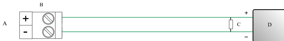
Figura 3-4: Cableado de la salida de mA (de energía interna)
