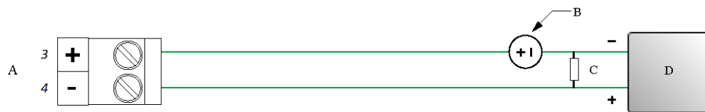
Figura 3-16: Cableado de la salida de frecuencia (de energía externa)
