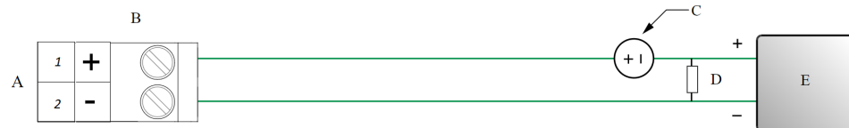
Figura 3-13: Cableado de la salida de frecuencia (de energía externa)
