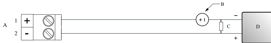
Figura 3-8: Cableado de la salida de mA/HART (de energía externa)
