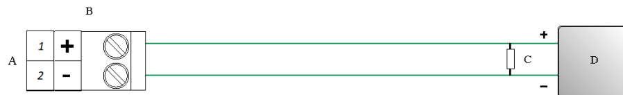
Figura 3-11: Cableado de la salida de frecuencia (de energía interna)
