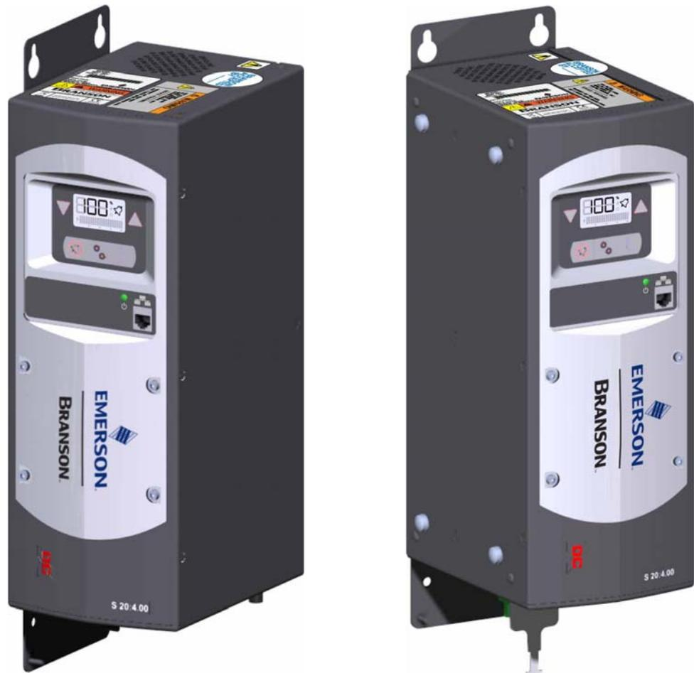
Il Generatore DCX HD genera energia elettrica ultrasonica tramite un convertitore di ultrasuoni per la saldatura di materiali plastici. Sono disponibili diversi modelli a seconda della frequenza desiderata (ad esempio 20 kHz), della gamma di potenza desiderata (ad esempio 4,0 kW) e della posizione di montaggio prevista (orizzontale o verticale). Il generatore contiene inoltre un modulo controllore a microprocessore che esegue il controllo e il monitoraggio delle operazioni di saldatura.
