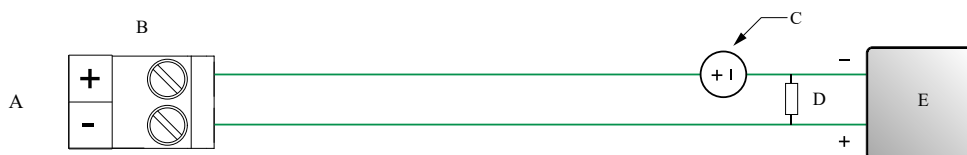
Figura 3-19: Cablaggio dell'uscita digitale (ad alimentazione esterna)
