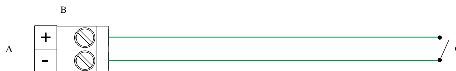
Figura 3-20: Cablaggio dell'ingresso digitale (ad alimentazione interna)
