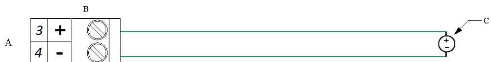
Figura 3-21: Cablaggio dell'ingresso digitale (ad alimentazione esterna)
