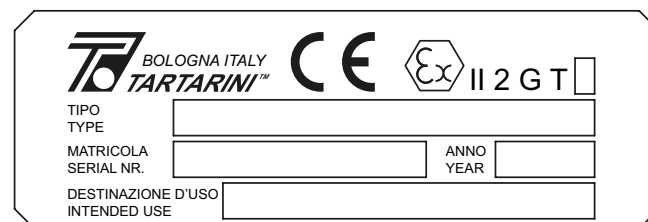
Рисунок 3. Этикетка для узла АТЕХ
