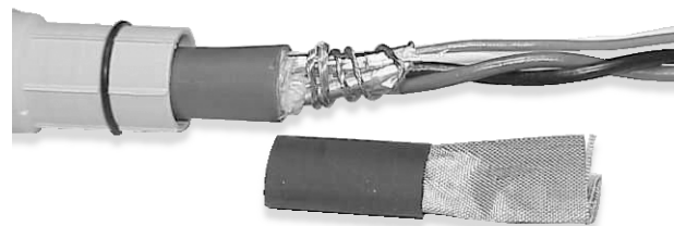
Εικόνα 7 Περιτύλιξη των συρμάτων της γείωσης θωράκισης
