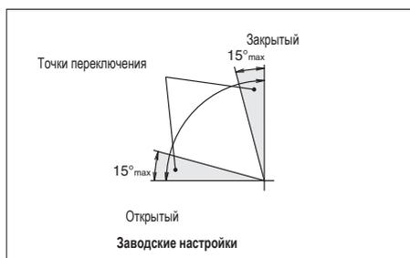
Рис. 5.1. Регулируемый диапазон и заводские настройки
