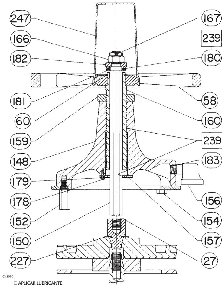
Figura 13. Conjunto de barra de volante montada en la parte superior para actuadores tamaños 70 y 87
