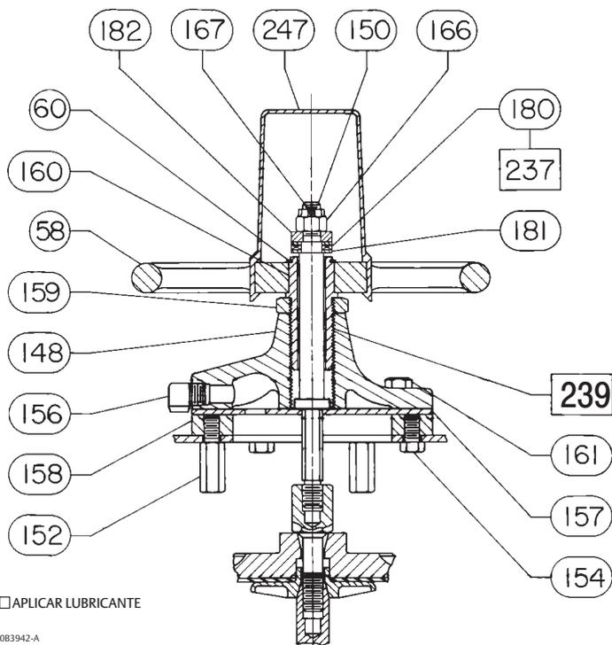
Figura 11. Conjunto de volante montado en la parte superior para actuadores tamaños 45 - 76
