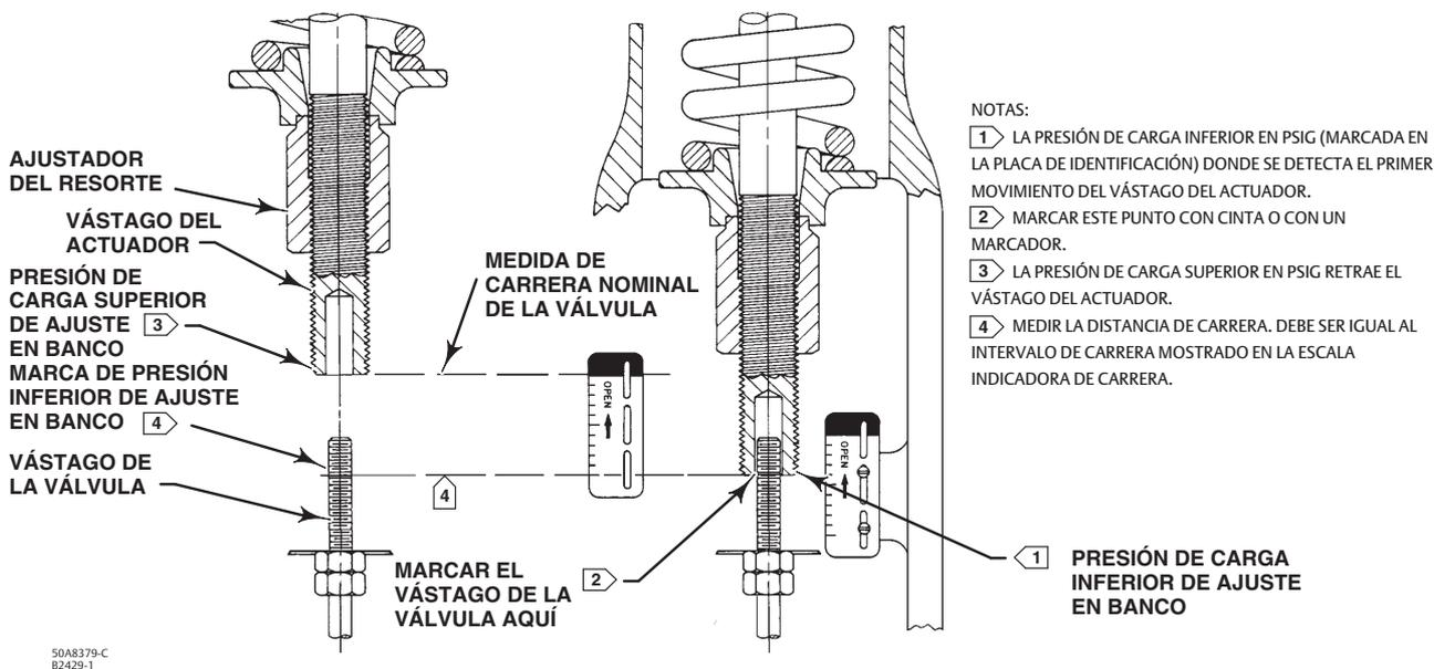
Es posible que sea necesario aplicar una presión de carga temporal al actuador para mover su vástago alejándolo de la válvula durante la instalación.
