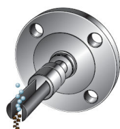
Figure 2-2: Installation de l'appareil en écoulement libre (montage sur weldolet)
