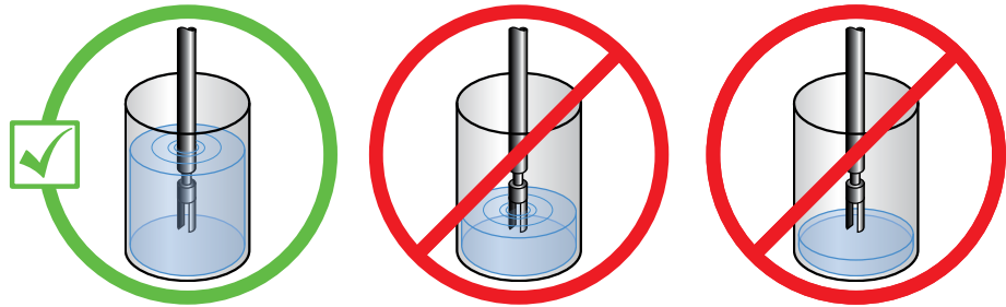
Figure 2-14: Position de l'appareil (immersion dans le fluide)
