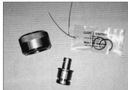
Componentes para la prueba hidrostática (Véase Nota 1)
