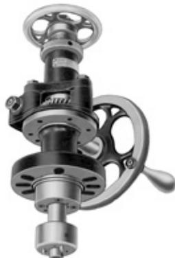
Máquinas de remecanización de asientos
