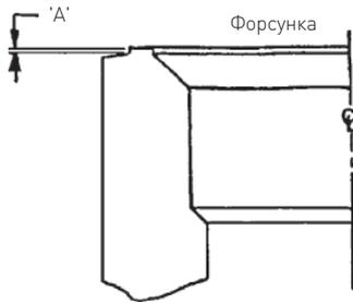
Когда расстояние 'A' меньше указанного ниже, седло форсунки должно быть подвергнуто механической обработке.
