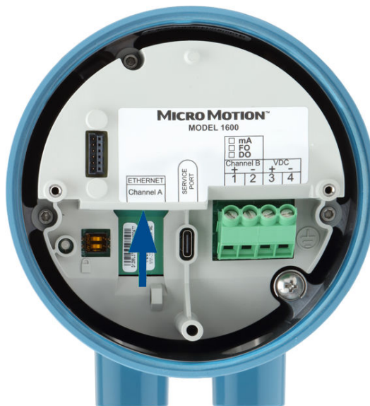
Illustration 5-2 : Raccordement de l'alimentation PoE à la voie A du transmetteur
