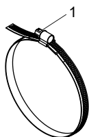
Fig. 6.20 : Bande de serrage avec fermoir de collier de serrage
