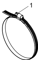
Fig. 6.51 : Bande de serrage avec fermoir de collier de serrage
