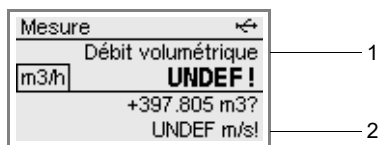
Fig. 13.1 : Vitesse d'écoulement en-dehors de la plage de validité
