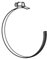
Fig. 6.13: Cinta de sujeción con cierre tensor rápido
