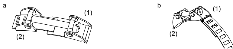
Fig. 6.78: Sensor de temperatura en la tubería
