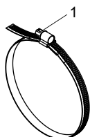
Fig. 6.20 : Bande de serrage avec fermoir de collier de serrage
