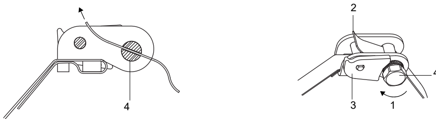
Fig. 6.21: Cierre de trinquete con cinta de sujeción
