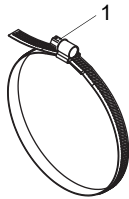
Fig. 6.25: Cinta de sujeción con cierre tensor
