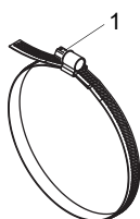
Fig. 6.50: Cinta de sujeción con cierre tensor
