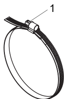
Fig. 6.19: Cinta de sujeción con cierre tensor
