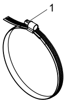
Fig. 7.20 : Bande de serrage avec fermoir de collier de serrage
