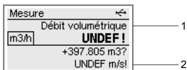
Fig. 14.1 : Vitesse d'écoulement en-dehors de la plage de validité
