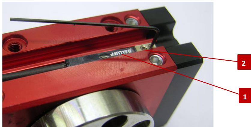
Fig. 21 Capteur de champ magnétique (représentation exemplaire)
