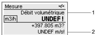
Fig. 13.1 : Vitesse d'écoulement en-dehors de la plage de validité
