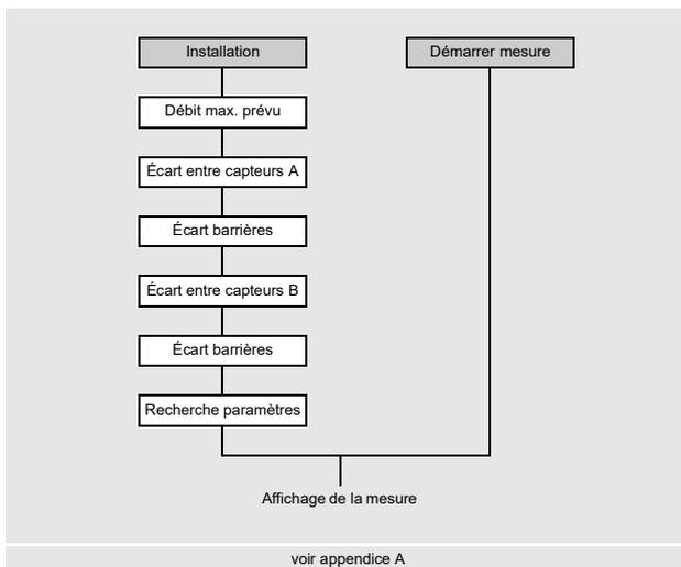
Avant le démarrage d'une mesure, le point de mesure doit être paramétré. Si une mesure avec les mêmes paramètres du point de mesure a déjà été effectuée, la mesure peut être démarrée immédiatement.
