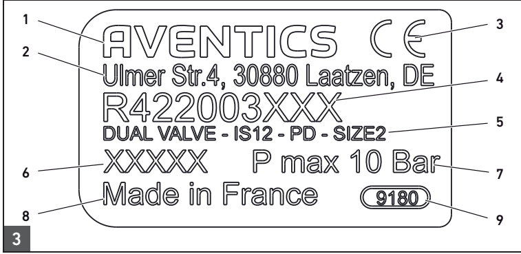
3 Typenschild | Plaque signalétique | Name plate | Targhetta dati | Placa de características | Typskylt 1: Firmenname | nom de la société | Company name | nome azienda | Nombre de la empresa | Tillverkarnamn 2: Firmenadresse | adresse de la société | Company address | indirizzo azienda | Dirección de la empresa | Tillverkarens adress 3: CE-Kennzeichnung | marquage CE | CE mark | marchio CE | Marcado CE | CE-märkning 4: Materialnummer | référence | Material number | codice | Número de material | Materialnummer 5: Typenbezeichnung | Désignation | Type designation | denominazione del tipo | Denominación de tipo | Typbeteckning 6: Fertigungsdatum | date de fabrication | Production date | data di produzione | Fecha de fabricación | Tillverkningsdatum 7: Maximaldruck | pression maximale | Maximum pressure | pressione massima | Presión máxima | Maximallt tryck 8: Herstellungsland | pays de fabrication | Country of manufacture | paese di produzione | País de fabricación | Tillverkningsland 9: Verantwortliches Werk | usine responsable | Responsible plant | stabilimento responsabile | Fábrica responsable | Ansvarig fabrik
