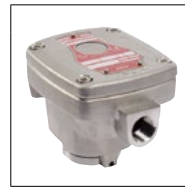
TYPE 04 : Acier inoxydable AISI 316L WSCR : EN/CEI 60079-0, 60079-1, 60079-31 WSCREM : EN/CEI 60079-0, 60079-7, 60079-18, EN/CEI 60079-31 WSCRIS : EN/CEI 60079-0, 60079-11, 60079-3
