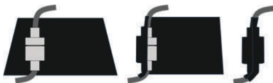
Obrázok 4-8: Aplikovanie koaxiálneho tesnenia na káblové prípojky
