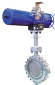
O projeto de flange único é mais econômico do que o de flange duplo porque requer menos material. Com insertos roscados em ambos os lados, é instalado usando dois conjuntos de parafusos e nenhuma porca. De acordo com as práticas comuns da indústria, os operadores tendem a evitar o uso desse tipo de corpo em diâmetros acima de NPS 36 devido às dificuldades operacionais na instalação da válvula.
