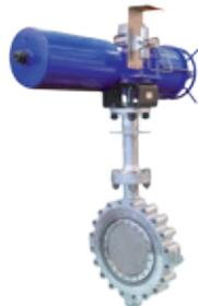
Bauart mit einem einzigen Flansch, durch den geringeren Materialbedarf entsprechend kostengünstiger. Die Installation erfolgt anhand der beidseitigen Gewindebohrungen mit zwei Schraubensätzen und ohne Muttern. Bei größeren Nennweiten als DN 900 (36") wird diese Bauform aufgrund praktischer Schwierigkeiten bei der Installation jedoch eher vermieden.
