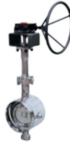
Die ideale Wahl, wenn die Anzahl der Flanschverbindungen reduziert werden soll. Gleichzeitig ist diese Bauform deutlich günstiger in der Anschaffung. Flüchtige Emissionen, wie sie bei Flanschverbindungen infolge der Spannungen im Rohrsystem auftreten können, sind dank der Verschweißung ausgeschlossen. Wie alle anderen Vanessa-Prozessklappen ist auch diese Ausführung im Betrieb wartungsfrei.
