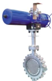
Construction simple bride plus économique qu'une version à double bride, car nécessitant moins de matériau. Avec inserts filetés des deux côtés, le corps est installé à l'aide de deux jeux de boulons sans écrous. Selon les pratiques courantes dans l'industrie, les opérateurs ont tendance à éviter d'utiliser ce style de corps pour des diamètres supérieurs à NPS 36 en raison de difficultés opérationnelles lors de l'installation de la vanne.
