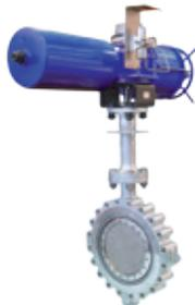
단일 플랜지 설계에서는 이중 플랜지보다 재료가 더 적게 필요하므로 더욱 경제적입니다. 양쪽에 나사산 인서트가 있어 너트 없이 2개 세트의 볼트를 사용하여 설치할 수 있습니다. 일반적인 산업 관행에 따라, 작업자는 밸브 설치 시 작업상 문제로 인해 NPS 36보다 큰 직경에 이 바디 스타일을 사용하지 않으려고 합니다.
