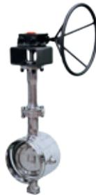
Идеальный выбор, когда необходимо уменьшить фланцевые присоединения, эта конструкция обеспечивает значительную начальную экономию затрат. Корпус под сварку встык полностью устраняет возможность утечек в атмосферу через фланцевое соединение, вызванных напряжением прилегающего трубопровода. Как и для всех затворов Vanessa серии 30.000, плановое техобслуживание не требуется.
