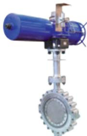
Однофланцевая конструкция более экономична, чем двухфланцевая, так как требует меньшее количество материалов. Имеет резьбовые вставки с обеих сторон и устанавливается при помощи двух комплектов болтов без гаек. В данной отрасли принято избегать применения этого типа корпусов для диаметров свыше NPS 36 в связи с эксплуатационными трудностями при установке затвора.
