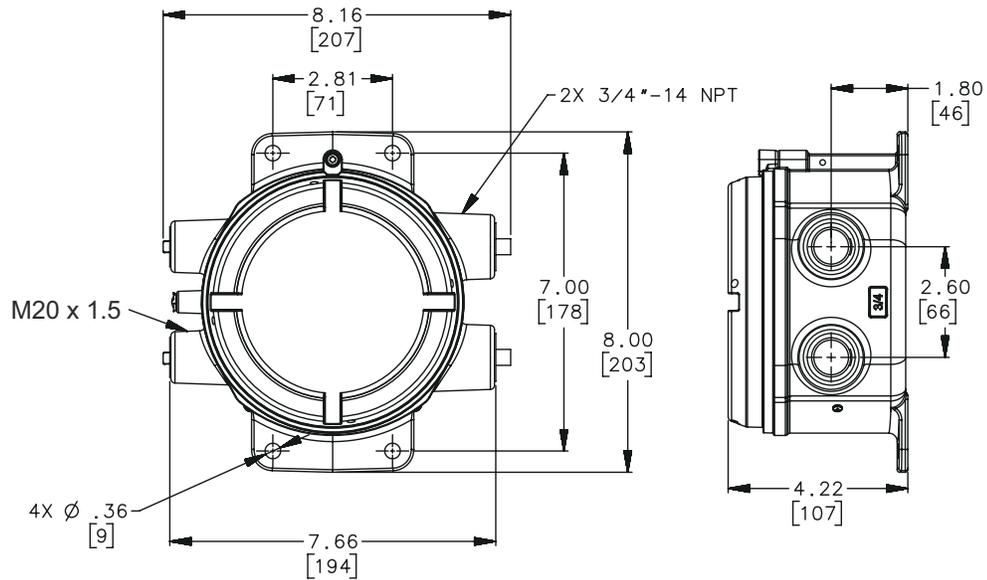
Корпус электронного блока удаленного базового процессора 800C
