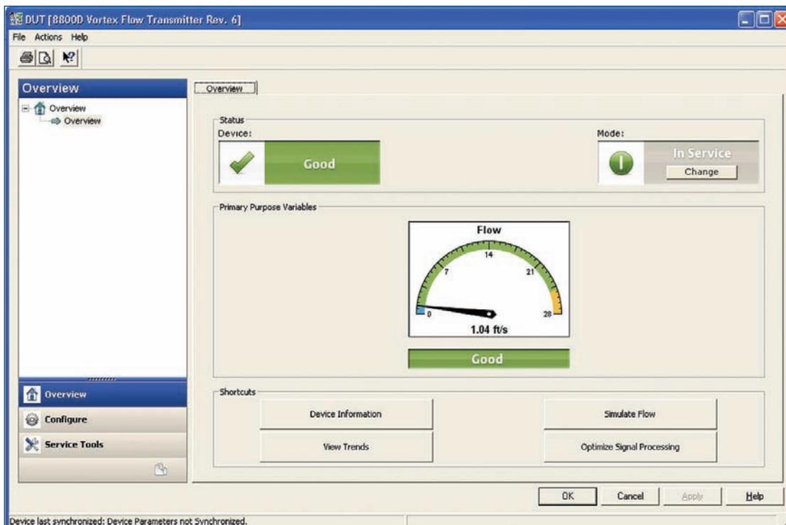
Com os alertas PlantWeb & telas de Status, é possível visualizar variáveis de processo, monitorar status de dispositivos e detectar alertas em qualquer instrumento conectado em seu sistema.
