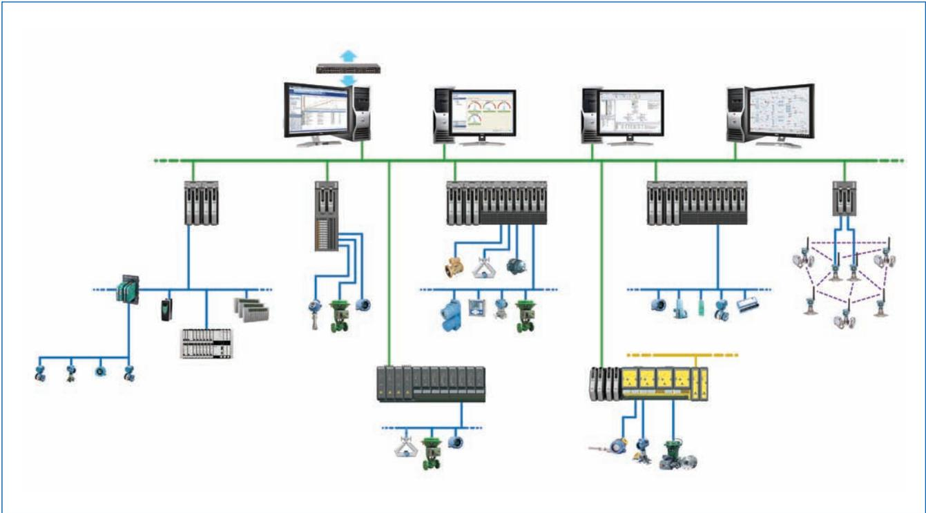
Die Verwendung des AMS Device Managers in Kombination mit dem DeltaV System ermöglicht, ohne zusätzliche Verdrahtung auf wichtige Geräte mit HART oder WirelessHART Protokoll über FOUNDATION fieldbus, PROFIBUS PA oder PROFIBUS DP zuzugreifen.
