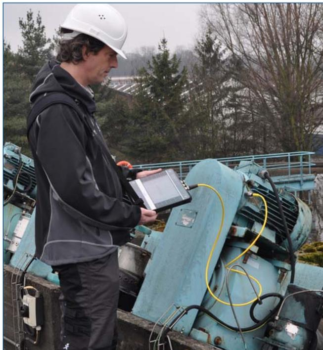
Анализатор технического состояния машинного оборудования CSI 2140 упрощает и повышает эффективность сбора и расширенного анализа данных.
