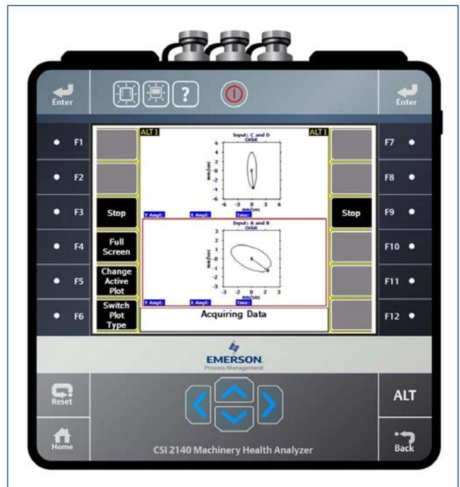
Наблюдение за двумя орбитами или движением центральной линии вала двух подшипников скольжения турбины, вентилятора или другого критического оборудования позволяет проводить безопасный запуск.
