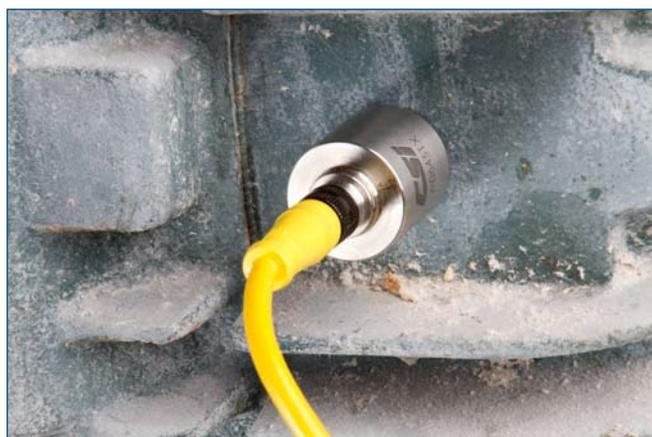
Акселерометр с тремя осями чувствительности позволяет собирать данные в вертикальном, горизонтальном и осевом направлениях в одной точке контроля одновременно.
