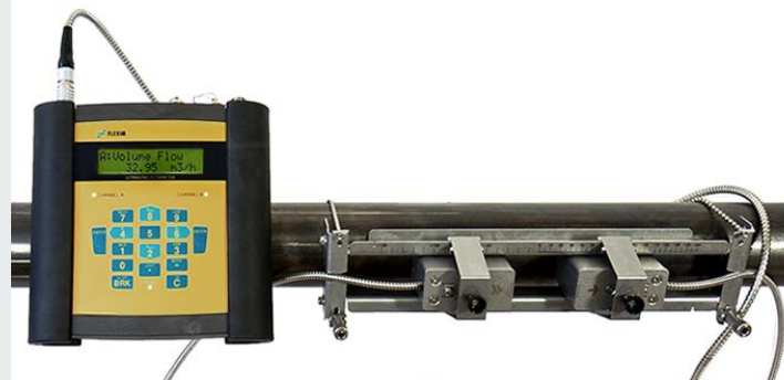
Meting met flowtransmitter met de buisklemming QuickFix
