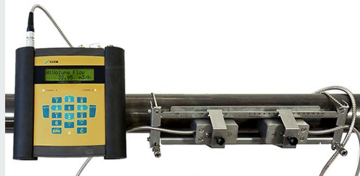
Meting met flowtransmitter met de buisklemming QuickFix
