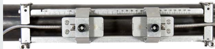
Meting met sensoren, gemonteerd met de draagbare Variofix VP
