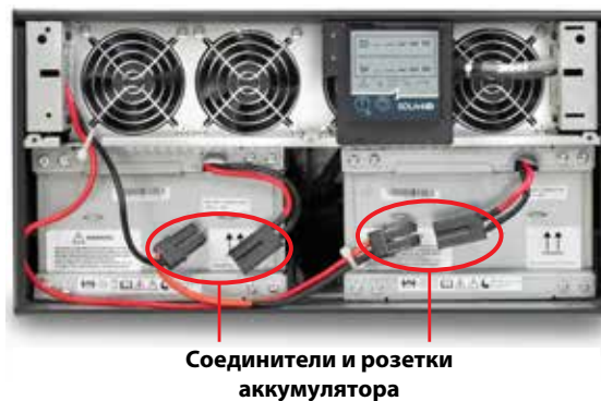
Рис. 26: Порядок отсоединения аккумуляторных блоков (вид спереди)
