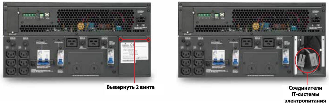
Рис. 22: Порядок снятия съемной панели IT-системы электропитания
