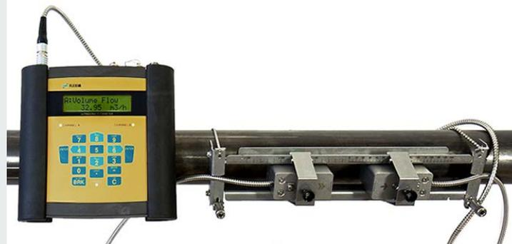
Messung mit Durchflussmessumformer, befestigt mit der QuickFix-Rohrbefestigung
