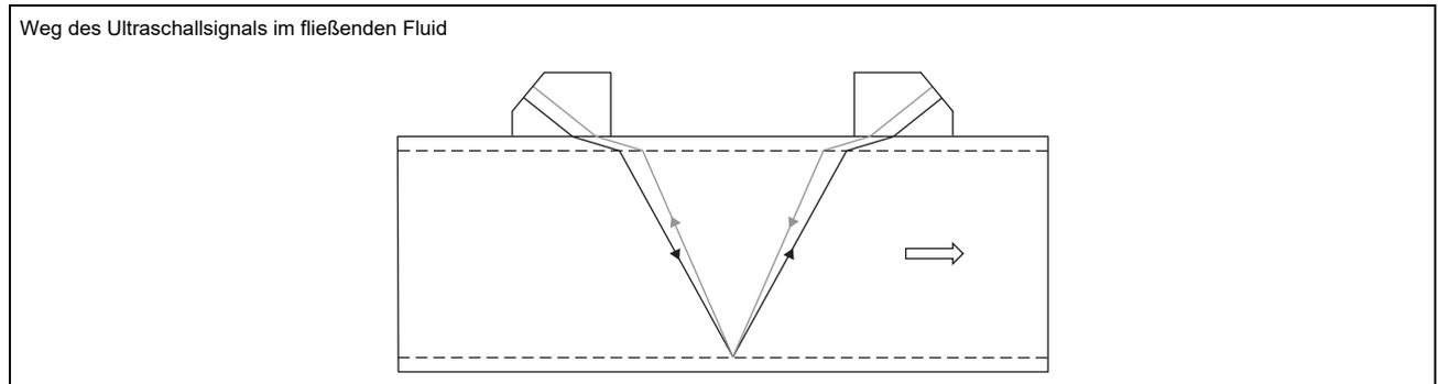
Da das Fluid, in dem sich der Ultraschall ausbreitet, fließt, ist die Laufzeit des Ultraschallsignals in Flussrichtung kürzer als entgegen der Flussrichtung.
