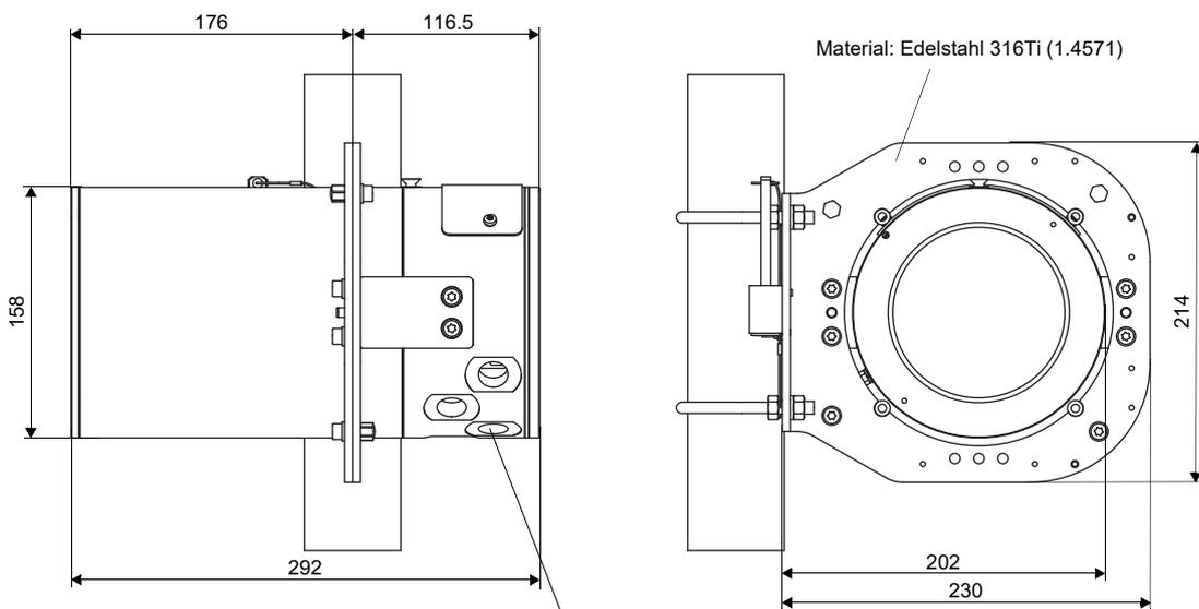
Gewinde, Kabelverschraubung: 5x M20 x 1.5
