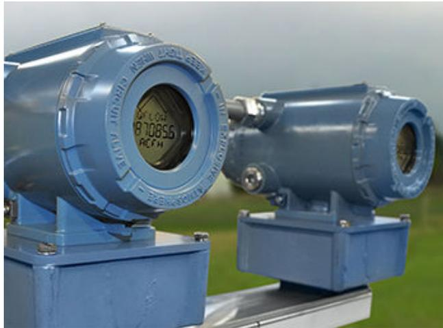
Das lokale Display ermöglicht die Anzeige von bis zu 10 Elementen, die aus 26 Variablen vom Benutzer ausgewählt werden können. Das Display kann so konfiguriert werden, dass die Volumeneinheiten als Ist- oder Tausenderwerte mit einstellbarer Zeitbasis von Sekunden, Stunden oder Tagen skaliert werden. Die Bildlaufrate kann zwischen 1 und 100 Sekunden (standardmäßig 5 Sekunden) eingestellt werden.
