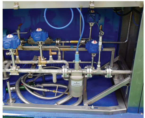
Emerson's Motion LNG meter inside a Graf DLNG dispenser
