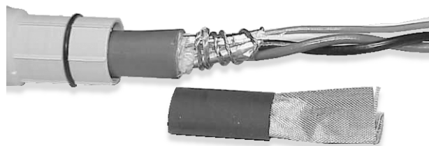
Afbeelding 3-6: Drain-draden afscherming tweemaal rond blootliggende folie gewikkeld
