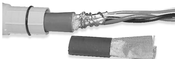
Figure 3-6 : Fils de masse du blindage enroulés deux fois autour de la feuille de blindage exposée
