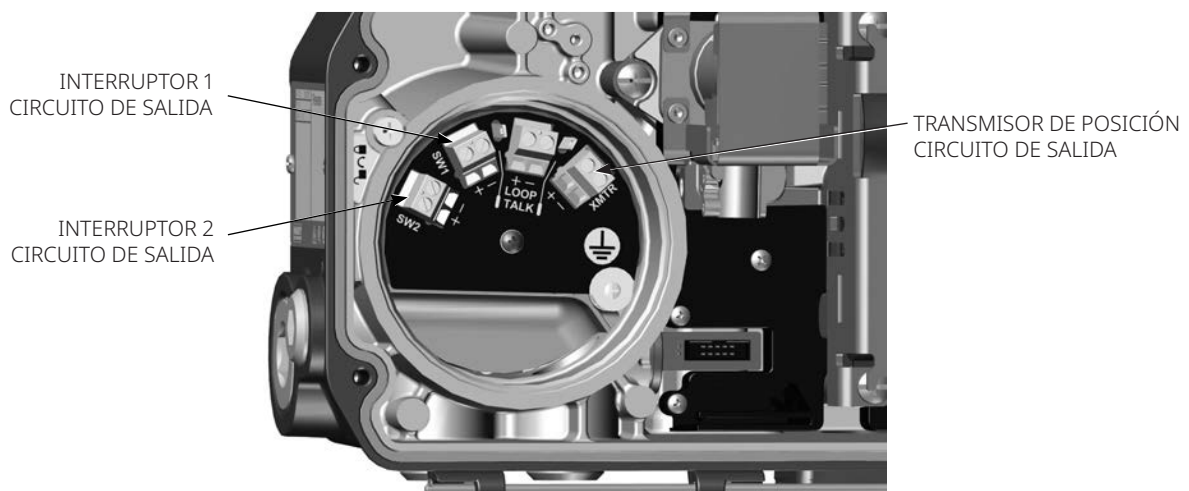
Figura 25. Opciones E/S: Transmisor de posición de 4 mA a 20 mA y dos interruptores de contacto seco de estado sólido
