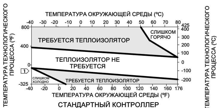
Рис. 5. Рекомендации по применению дополнительного теплоизолятора
