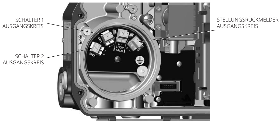
Abbildung 25. E/A-Optionen: 4 bis 20 mA-Stellungsrückmelder und zwei Festkörper-Trockenkontaktschalter
