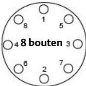
Figuur 9. Aanhaalvolgorde flensbouten
