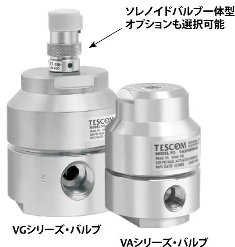
TESCOM VAおよびVGシリーズは、ノーマリーオープン/ノーマリークローズ機能、41.4、68.9、103 MPa / 6000、10,000、15,000 psigの作動圧力、高耐久性を備えたエア作動バルブです。オプションでソレノイド作動バルブも可能です。液体および気体用途に最適です。
