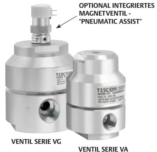
Die TESCOM-Serien VA und VG beinhalten pneumatisch betätigte Ventile, drucklos geöffnet oder drucklos geschlossen, für Arbeitsdrücke von 414, 690 und 1035 bar, die sich durch eine sehr lange Lebensdauer auszeichnen und optional mit einem integrierten Magnetventil ausgestattet werden können. Geeignet für Flüssigkeits- und Gasanwendungen.
